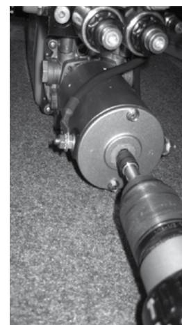
*Lors du montage, il convient de tenir compte du dispositif de commande manuel de secours de la pompe.*
